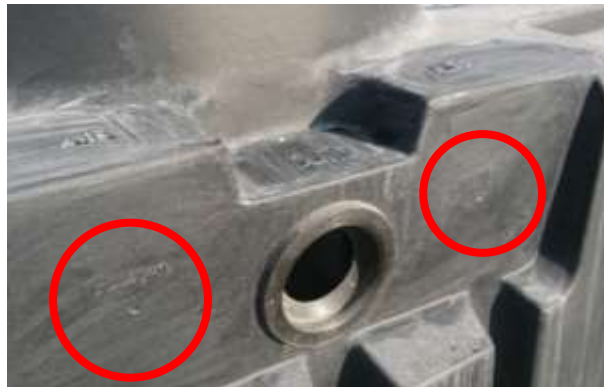
Fig-19 : Points de percement de la cuve R-90 pour aération
