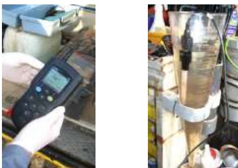
Fig-9 : Mesure du PH et de l'oxygène
